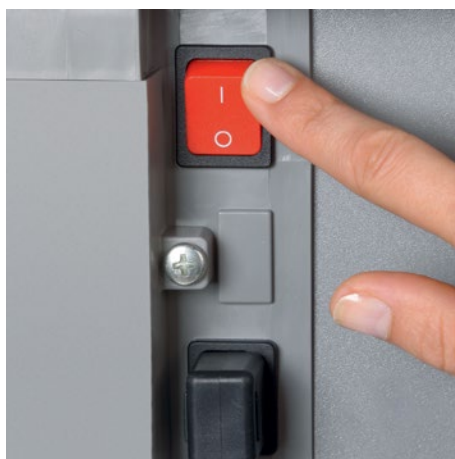
Oddzielny główny wyłącznik jest ulokowany w tylnej części niszczarki i całkowicie odcina ją od prądu
