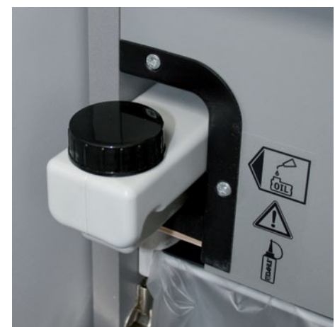
Zintegrowany automatyczny podajnik oleju do automatycznego olejowania cylindrów tnących pomaga wydłużyć ich żywotność
